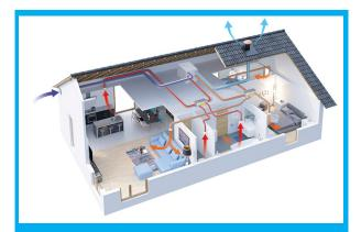
La VMC DF KALIX 90 est un système d'extraction et d'insufflation motorisé avec échange thermique entre l'air vicié et l'air neuf. Elle permet d'extraire l'air pollué vers l'extérieur et de filtrer l'air entrant.
